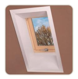
Внутренний оконный короб предназначен для быстрой отделки оконных откосов в мансарде. Позволяет дополнительно утеплить окно и не ограничивает угол падения света. Оконные короба изготавливаются из водостойких ламинированных ДСП, что делает их долговечными и практичными. Оконный короб XLC-F предназначен для деревянных окон, а короб XLC-P – для пластиковых окон. Короба доступны в двух версиях: шириной 30 см и 40 см.
