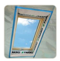
Оклад XDS – оклад, который соединяет пароизоляционный слой с коробкой окна и защищает теплоизоляцию в зоне окна для крыши от водяных паров. Оклад XDS устанавливается в специальный паз на коробке окна, отличается простым и быстрым монтажом. В комплект входит самоклеющаяся лента для герметичного соединения с основным пароизоляционным слоем. Используется для окон, установленных в крышу с углом наклона от 30° до 60°.
