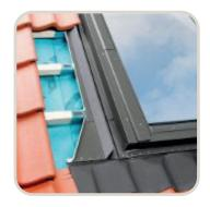
Оклад EHN/V-AT Thermo на 22 мм шире стандартного, имеет дополнительную изоляцию и элементы утепления с внутренней стороны оклада. Монтаж мансардного окна в комплекте с окладом EHN/V-AT Thermo обеспечивает надёжность от протечек и промерзания даже в самых экстремальных погодных условиях. Подходит для всех типов кровельных покрытий.
