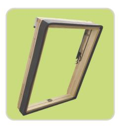
Теплоизоляционный пояс XWT/XWT Plus предназначен для улучшения теплоизоляции в зоне окна для крыши. Пояс изготовлен из вспененного полиэтилена с самоклеющейся поверхностью. Пояс позволяет легко и профессионально утеплить окно. Для монтажа теплоизоляционного пояса достаточно натянуть его по периметру оконной коробки.
