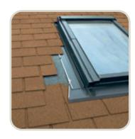
Оклад ESV для плоских кровельных покрытий позволяет герметично соединить мансардное окно с плоскими кровельными материалами: кровельное железо, гибкая черепица, различные непрофилированные кровельные материалы до 10 мм. В стандартном варианте окно с окладом ES устанавливается на глубине посадки V (на 30 мм ниже других окон).
