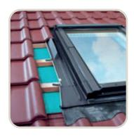
Оклад EZV-A – это универсальный оклад, позволяющий герметично соединить окно с профилированными кровельными материалами: профнастил, черепица, металлочерепица. Используется для всех типов кровли с высотой профиля до 45 мм. В стандартном варианте оклад E\_N-A устанавливается на глубине посадки V.
