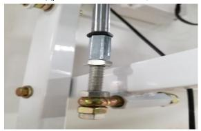
4. Концевой выключатель сверху не подлежит регулировке, концевой выключатель на двери был отрегулирован при тестировании лестницы на заводе в зависимости от высоты, предоставленной клиентом. Но иногда между реальной высотой и высотой, предоставленной клиентом, может быть большая разница, поэтому в этом случае клиенту необходимо отрегулировать концевой выключатель в нижней части люка.
