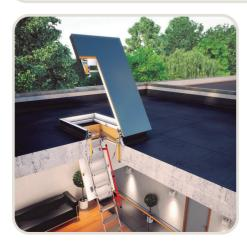
Люк DRL предназначен для удобного и безопасного выхода на крышу, обслуживания кровли и проведения других сервисных работ. Обладает высокими параметрами теплоизоляции и герметичности (толщина утеплителя – 44 мм), а также устойчивостью к механическим повреждениям. В отличие от окон-люков люк DRL изготавливается из многокамерного профиля ПВХ и не имеет стеклопакета. Створка люка имеет угол открывания до 60° и возможность фиксации, что позволяет легко и беспрепятственно выйти на крышу.
