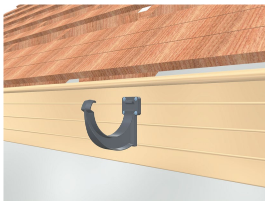
Рис. 11 Особенности монтажа кронштейнов на полимерный материал
